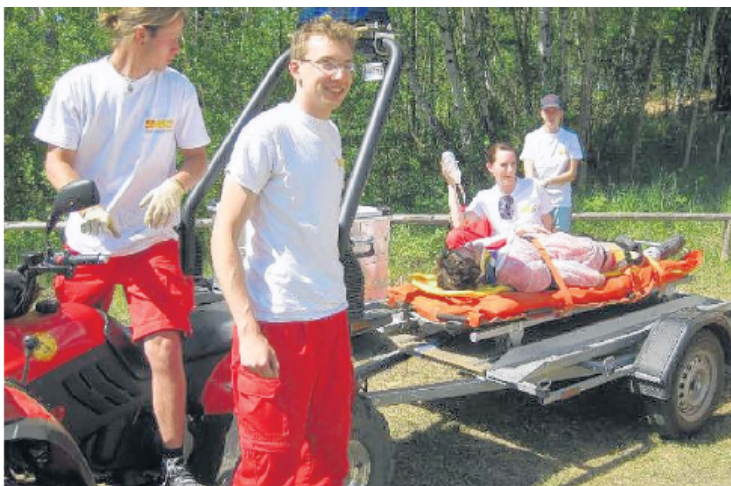
Ein Quad mit Allradantrieb, bei der Übung erstmals eingesetzt, hat sich als Rettungsfahrzeug bewährt. Auf dem Anhänger können Personen auch aus schwierigem Gelände geborgen werden. FOTO: FRWA 7
